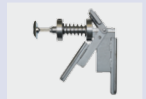
Verbindermontage mit FH-Einpresswerkzeug
